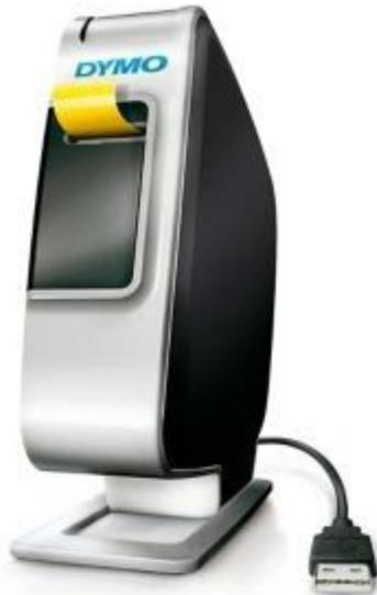
Attention, cette étiqueteuse étant limitée à des rubans de 12mm, elle ne permet pas d'imprimer des QrCode lisibles. Elle a donc été délaissée par le laboratoire IRAP à l'origine du logiciel LabInvent.
