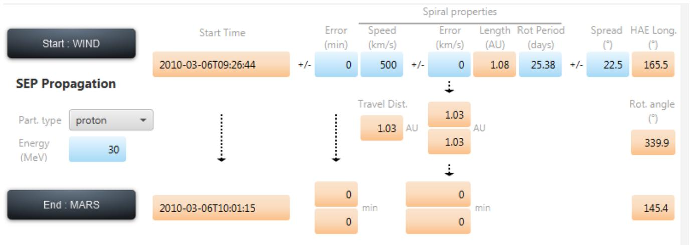
Cette interface permet d'ajuster les paramètres et de présenter les résultats de propagation SEP entre le « Start » et le « End ».
